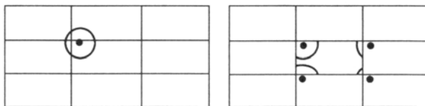
图 4.1.3.4-1 (左) 每个粒子有一个 Verlet 列表的通常方法；(右) Bekker 方法，每个粒子的周期性映像都有其自己的 Verlet 列表，表中只含有在原胞中的粒子。
